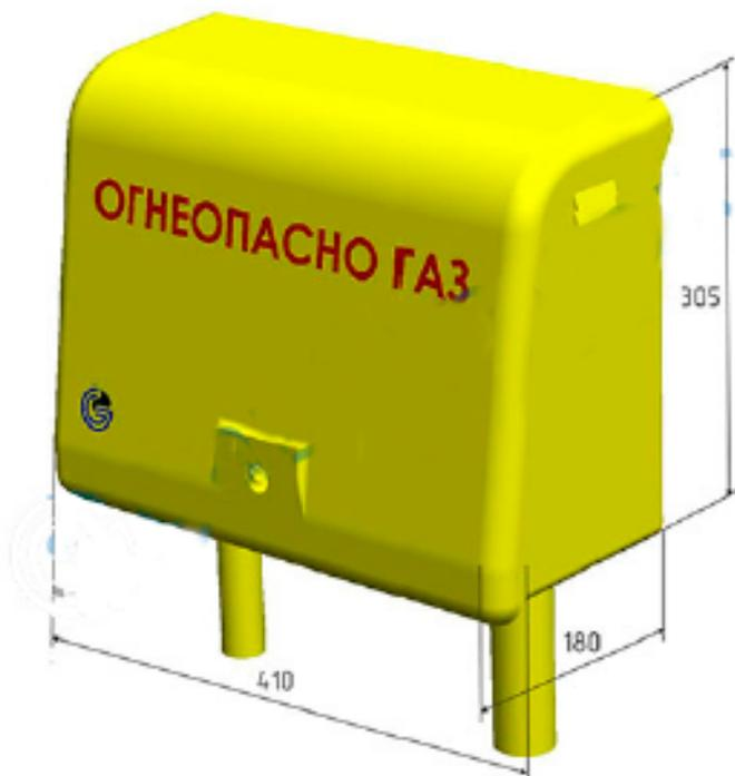
ДРП(FE25)- домовый газорегуляторный пункт с регулятором FE-25 производство «Fiorentini» ; способ установки - крепление на опоре.
