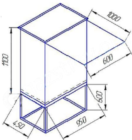
Домовой газорегуляторный пункт изготовлен в виде металлического шкафа или шкафа из композита, внутри которого расположено оборудование. Композитный шкаф обладает вандалоустойчивостью, не поддерживает горение.
