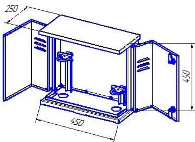
ДРПК(FES50)- домовый газорегуляторный пункт с кронштейном с регулятором FES-50 производство «Fiorentini» ; способ установки- крепление на опоре.
