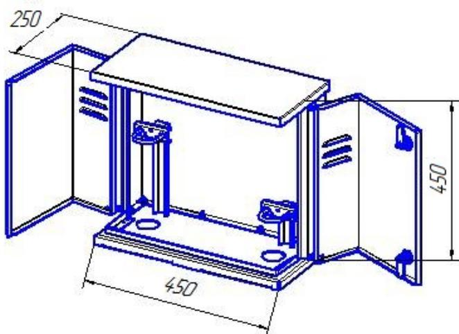
**ДРПК(R70 TARTARINI)**- домовый газорегуляторный пункт с краном на входе с регулятором R70 производство «TARTARINI» ; способ установки - крепление на опоре.
