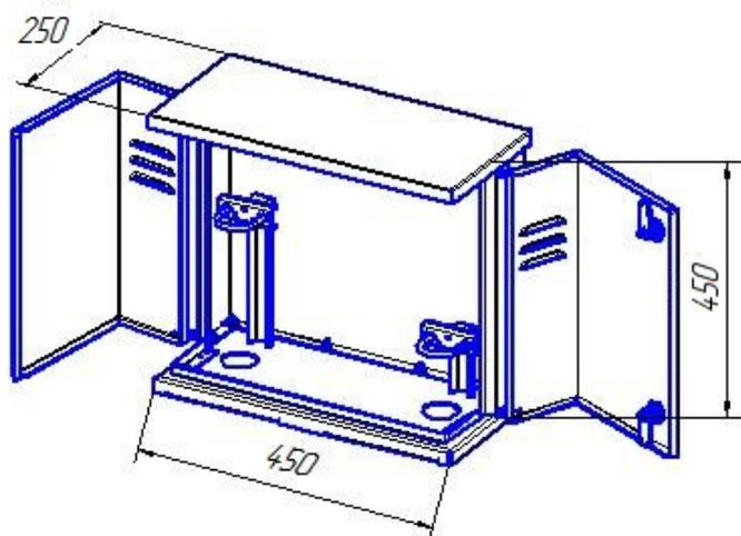
**ДРП CL (FRG/ 2MB-K-R DN25)** – домовый газорегуляторный пункт с регулятором давления FRG/ 2MB-K DN25 со штуцером отбора давления газа типа ПЕТЕРСОН производство «MADAS»; линейное исполнение ; способ установки – крепление на опоре.
