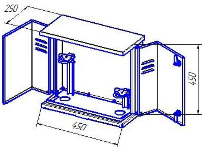
ДРПК(RF25)- домовый газорегуляторный пункт с кронштейном с регулятором RF-25 производство «ООО ФАРГАЗ Рус» ; способ установки- крепление на опоре.
