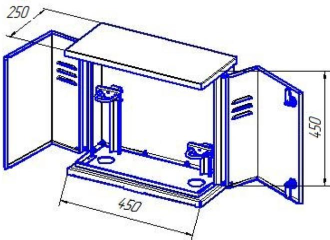
**ДРП К (FRG/2МВ-С-Р DN25) до 30 м³/ч** – домовый газорегуляторный пункт с регулятором давления FRG/ 2МВ-С DN25 со штуцером отбора давления газа типа ПЕТЕРСОН производство «MADAS»; линейное исполнение ; способ установки – крепление на опоре.
