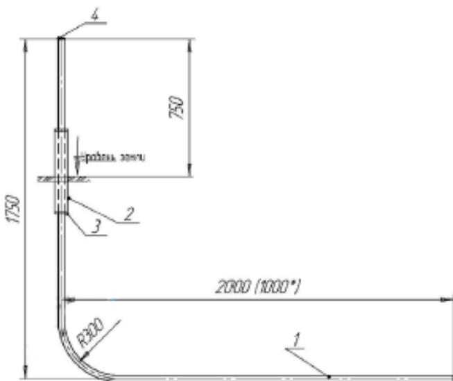
Цокольный ввод с переходом полиэтилен-металл выполнен без сварного стыка с использованием трубы с двухслойным покрытием на основе экструдированного полиэтилена с толщиной изоляции 2,5-2,8 мм. Изготавливаются длиной 1 метр для газопровода низкого давления и 2 метра для низкого, среднего и высокого давления.
